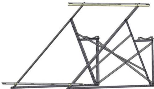
Posizionare al 2° foro inferiore la barre di supporto collettori lunga 1005 o 2000 mm a seconda del modello.
