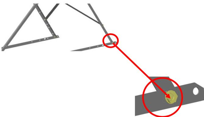
Fissare la Barra L -1270 al 2 ° foro della barra L-2000.
