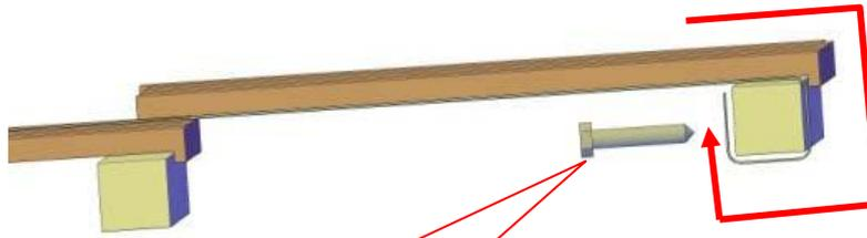
Fissare le Bande Inox forate con il Bullone M8X50.
