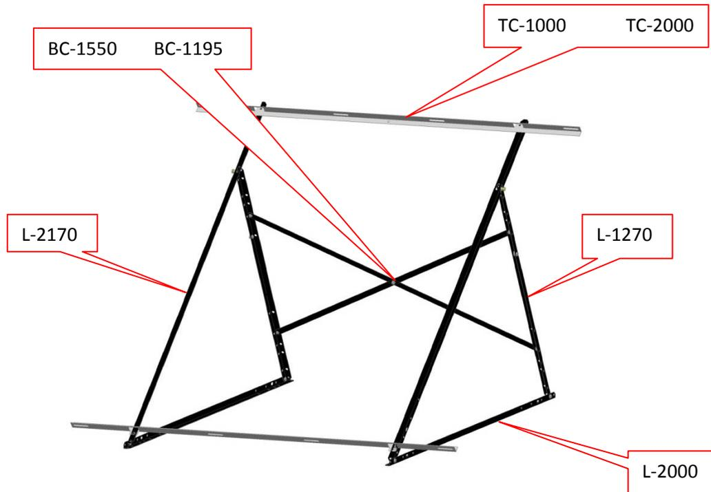
Per l'installazione del telaio su lastrico solare si utilizzano i seguenti componenti:
