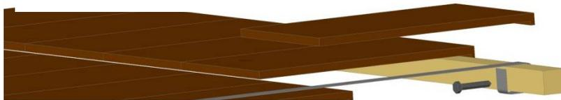
Unire il 1° foro della barra L-2170 al 2° foro della barra L-2000 e bullone uso e dado per fissare assieme, come è mostrato di seguito:
