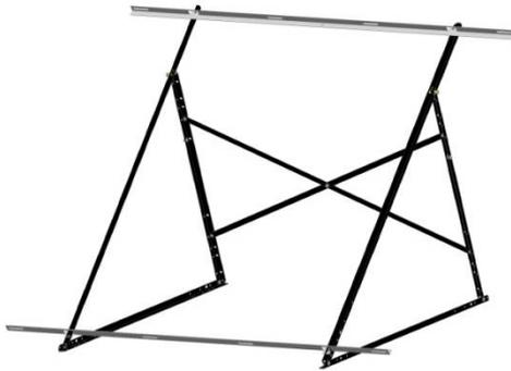
Ponete al 2° foro ad asola della barra L-2170 le barre orizzontali di sostegno dei collettori lunghe 1005/2000 a seconda del modello di staffe da 1 o 2 pannelli.
