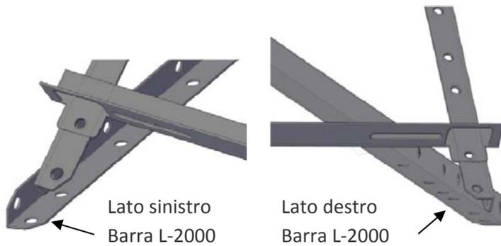
Posare a terra le due barre L-2000, parallelamente tra loro con l'aletta disposta all'interno. La distanza tra loro deve essere di 940 mm per il modello cod.5231469003454 cod .5231469003388
